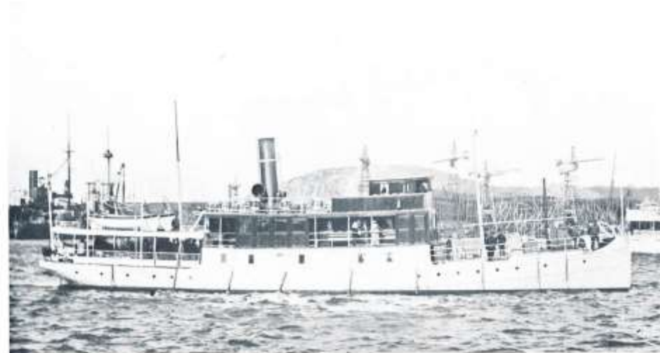
S:t ERIK efter den stora ombyggnaden år 1920 då styrhytten flyttades upp till båtdeck och matsalongen flyttades till övre däck. Foto från Dag Almén.
