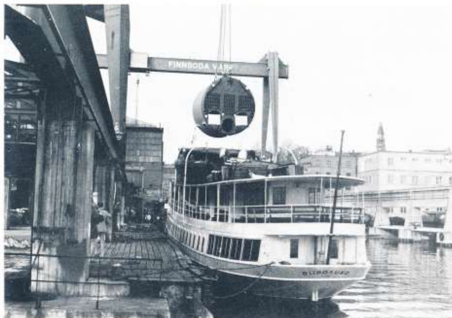
BLIDÖSUNDS nya ångpanna sänktes ner i fartyget vid Finnboda Varf den 5 april 1982. Pannan har byggts vid Götaverken Angteknik i Göteborg. Foto Christer Samuelsson.
