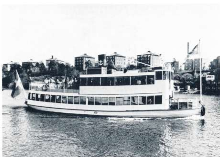
"Nya" DROTTNINGHOLM invigningsdagen den 14 maj 1982. Styrhytten går från sida till sida och akterdäcket saknar ännu regnskydd. Livbåten har flyt- tats upp på taket medan en stuv flytredskap skymmer skorstenen. Foto: Christer Samuelsson.
