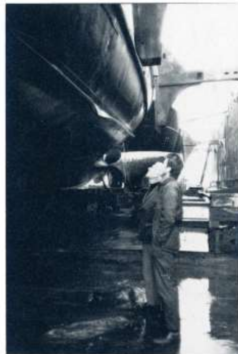
Ralph Davidsson och Stefan Westerberg begrundar bordläggningsplåten som skulle bytas strax ovanför och framför den tillstuckade slingerkölen.
