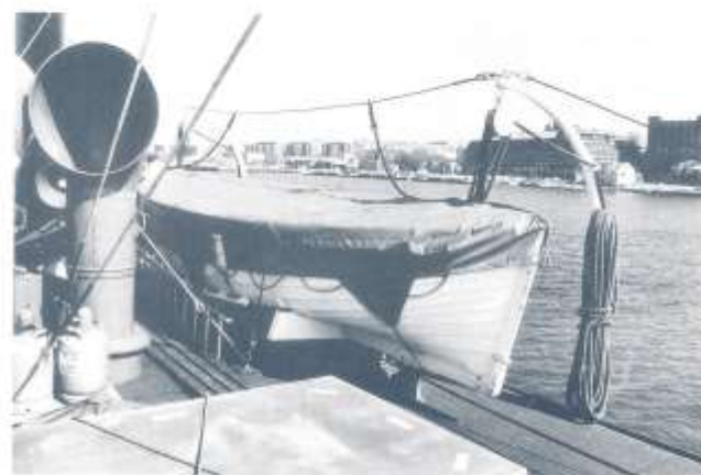
Styrbords livbåt ren och prydlig. Till vänster en av maskinrumsventilatorerna. Hitom denna de två gasbehållarna för pentret. Foto: Bo Starmark 1993.
