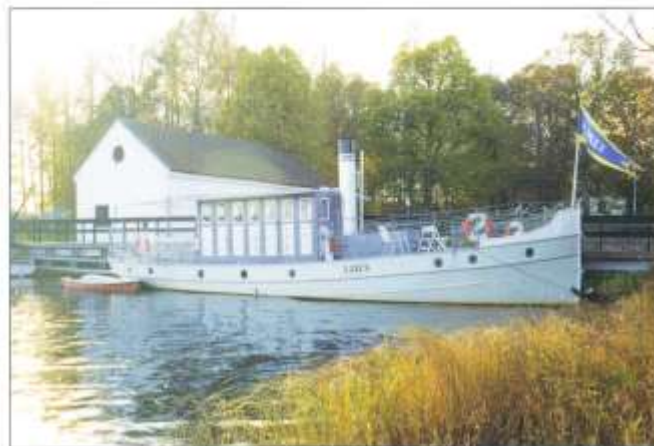
LAXEN är 17,4 m lång och ca 4 m bred. Den har ångmaskin för framdrivningen och ett ångdrivet spel under däck med 1200 m wire för att spela hem timmer över de stora fjärdarna på Dalälven. Foto Rolf Lundén
