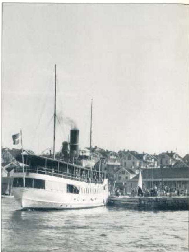
Ångaren BOHUSLÄN vid Fiskebäckskils brygga. Vid avgång var man tvungen att backa på akterspring för att gå klar från Mansbalmen på babordssidan. Akterdäckets lastportar och pollaren för akterspringet var belägna i det närande pentryt. Foto från Svenska Väst-kustfiskaren.
