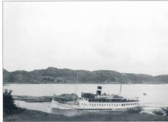
BOHUSLÄN passerar mellan Malmön och Ställkäret på en nordgående expresstur 1957 eller 1958. I bakgrunden skymtar vägfarjan vid Tallbodens färjeläge. Bilden visar BOHUSLÄN som hon såg ut efter ombyggnaden för Öresundstrafik 1953 med inbyggt akterdäck och en extra livbåt. Skerstens brodu visa fält markerade Marstrandsbolagets ändrade ägorförhållanden från 1956. Foto Ralph Grundell.
