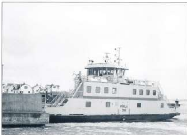
Vägfärjan ULRIKA (FARIA 308) på väg in till Röro färjeläge 16 februari 2003. Ulrika är 40,4 m lång, 9,17 m bred och har ett djupgående på 3,2 meter. Färjan har fyra dieselmotorer på totalt 810 kW parvis kopplade till två Aquamaster propelleraggregat. Foto Ingvar Kronhamn
