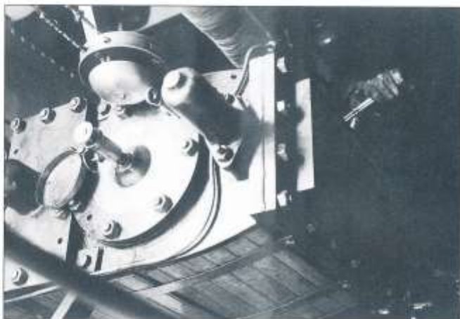
EJDERN maskintopp med högttrycks cylindern. Till höger skymtar Bertis band på ångpådraget. Foto: Gunnar Söderberg på Älvsborgsturen 29 maj 1976
