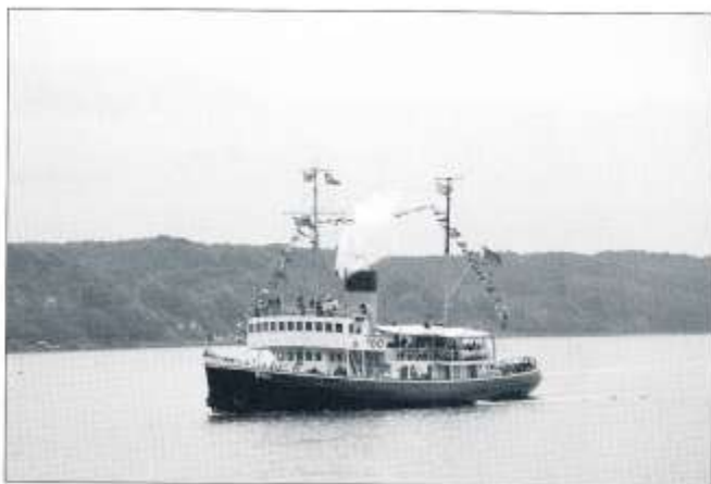
Wsa byggdes i Ström 1938 för isbrytning i Kierikalanen. Den är 50 meter lång och har en trippelångmaskin på 1200 hästkrafter. Wsa är sedan 1990 museifartyg i Bremerhaven. Foto Mats Demker
