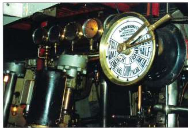
Ångmaskinen är ångaren BOHUSLÄN s hjärta. Telegrafan står på full fart framåt. Foto Ingöf Ibenhard Benjaminsson
