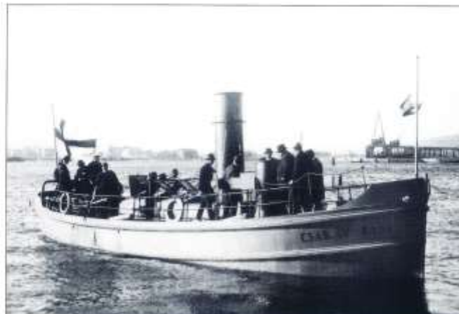
Herrar i hatt och rock på proccar med Esab IV vintern 1921. Fartyget såldes vid den här tiden utbytt. Esab IV är idag världens äldsta helsvetsade fartyg. Foto från Fotopumpen
