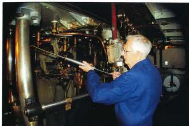
Lågtryckarens tvärsnitt möter med gejdspretan av Bengt Fors. Foto Bo Starmark
