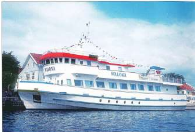
WALONA byggdes 1986 i Norge. Fartyget är byggt av plåt, är 30 meter långt och kan föra 250 passagerare. Med sina tre dieselmotorer går WALONA 18 knop. Foto Ingvar Kronhamn
