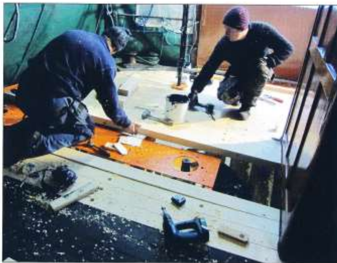
Nytt fördäck på FÄRJAN 4 läggs av snickarna från Ocean Snickeri från Öckerö. Foto Per Ahlqvist
