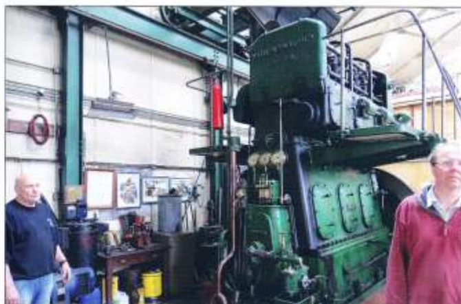
Waddonmaskinen från 1910 är en imponerande kompositmaskin där förlängningen av kolostängarna driver var sin kolpump.
