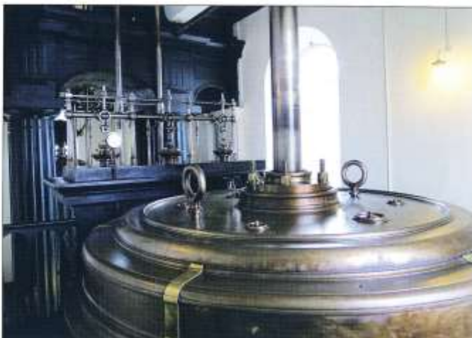
Maskintoppen på balansmaskinen från 1846 med 90 tum cylinderdiameter. Maskinen är så stor att den går genom flera våningsplan
