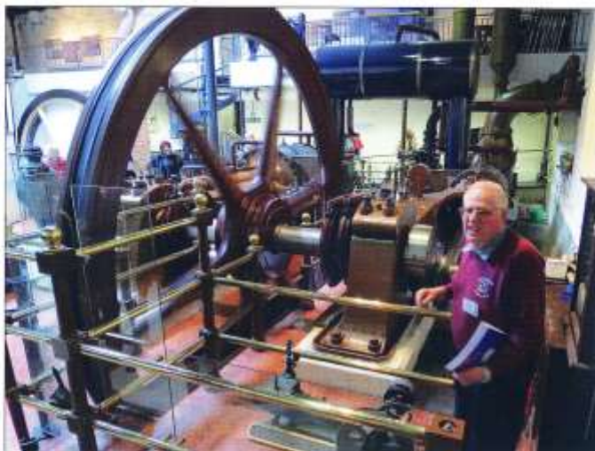
Waddonmaskinen från 1910 är en imponerande kompositmaskin där förlängningen av kolostängarna driver var sin kolpump.
