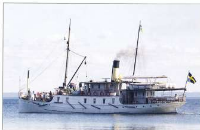
Ångaren TRAFIK kunde fortsätta trafikera Vättern även när nya föreskrifter krävde godkänd läckstabilitet. Lösningen blev ett skott i lastrummet som med stabilitetsövövningastade föreningen drygt 400 000 kronor. Foto: Göran Magnusson
