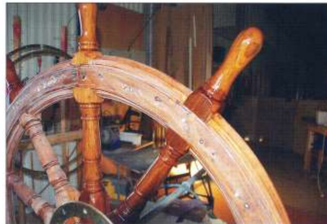
Ratten uppbänd i Arne Apelmans båtverk. Den mörkare nyansen på de nya delarna syns tydligt. Notera att den övriga delen av ratten är mattslipad. På väggen hänger de två mässingsbanden.
