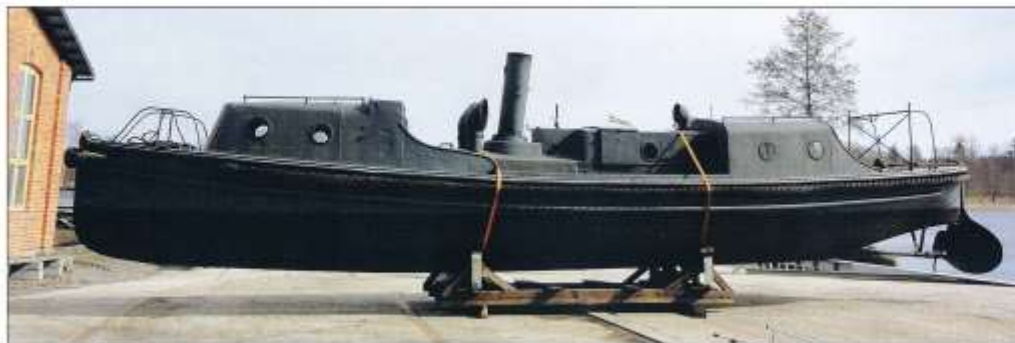
Ångslup 45 i profil i Forsvik. Först inredning för besättning, midskotts ångpanna och ångmaskin, akterut inredning för medföljande passagerare. Foto Per Hilding
