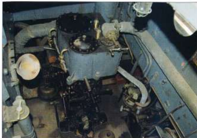
Kompondångmaskinen i Ångslup 45. På förkant snäckväxel för drift av matarvattenpump och länsypump. Foto Bo Starmark
