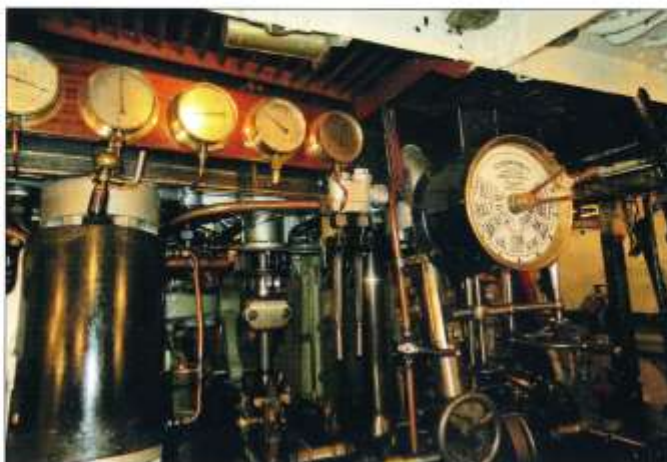
Borsula maskin under gång i ekonomifart med 6 kg/cm 2 ångtryck in i högttrycks cylindern. Foto: Gunnar Stålerberg
