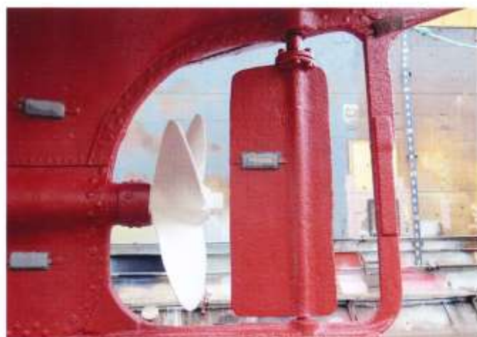
Förligt roder ställt för gång framåt och dragande propeller. Även här är den stora roderarean akter om roderaxeln. Foto Gunnar Söderberg 4 dec 2014
