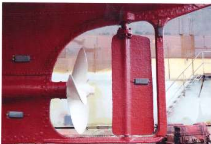
Akter roder ställt för gång framåt och tryckande propeller. Den stora roderarean befinner sig akter om roderaxeln. Foto Gunnar Söderberg 4 dec 2014
