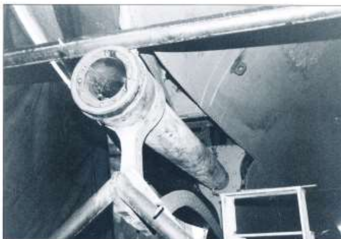
Bilden visar propellerhysan sedd akterifrån i januari 1991. Längst in syns akterpiktankens förliga skott. Under propellerhysan syns kröken på stängkålen och det syns även att skäddan är avskuren.
