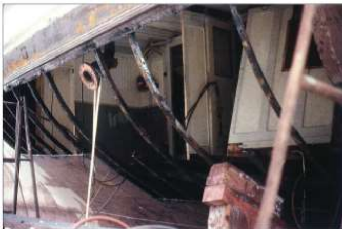
Donsö Varv den 20 januari 1979. Här är C-, och D-stråken samt några spant utskurna styrbord akter. Från vänster skimtar aktersalongen, de båda hytterna, damsalongen och en bit av maskinrumskottet. Även E-stråket överst skulle bytas.
