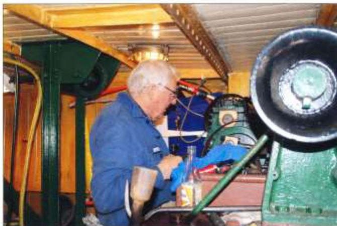
Chefen Håkan Rosell i arbete med lastrumsvinchen. Vinschen var avsedd att lyfta gods ut lastrummet. Den kan också kopplas till ankarspelet på fördäck genom en ändlös kätting. Foto 25 oktober 2018.
