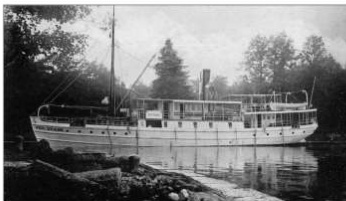
På denna bild av PER BRAHE ser man hur ångaren var disponerad med halvdäck i för och akter. Lastporten leder in till vad som kallas mellandäck, utrymmet mellan huvuddäck och bryggdäck. Foto från Ragnar Magnanders samling
