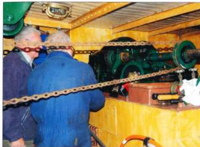
Vinschen är kopplad med kättingen till ankarspelet. Steinar Lå och Håkan Rosell sköter vinschen och ser till att den fungerar som den ska. Foto Bo Starmark
